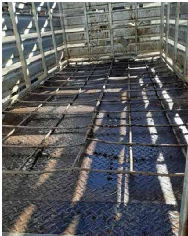
**Figura 5.** Pisos inadecuados según la Resolución SENASA 503/2022. Con el tiempo, cuando las mallas cuadriculadas no están bien encastadas, pueden terminar como en la fotografía y generar salientes que dañen a los animales.
