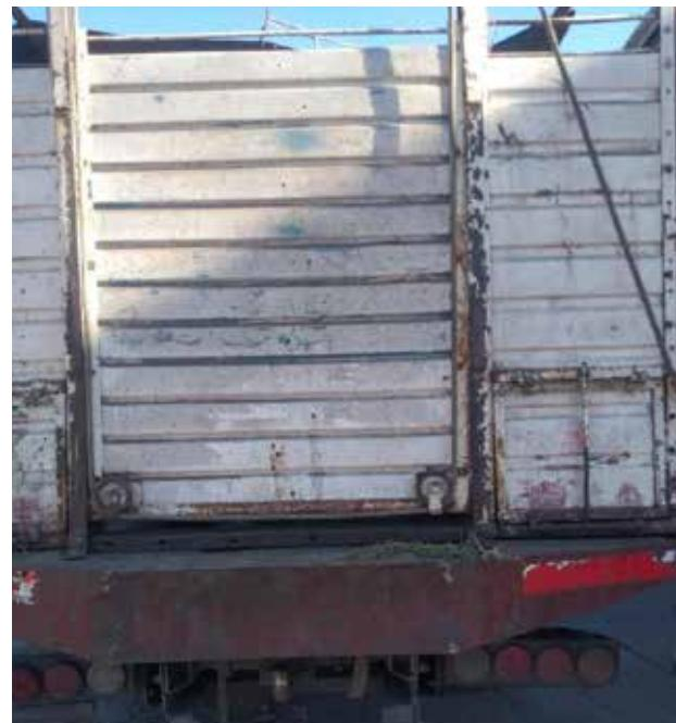
**Figura 12.** Ausencia de rodillos giratorios externos. Inadecuado según la Resolución SENASA 557/2024.
