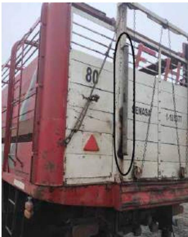
**Figura 9.** Está marcado uno de los rodillos giratorios externos. La función de estos es absorber el impacto de los golpes laterales cuando el animal sube o baja del camión. Adecuado según la Resolución SENASA 557/2024.
